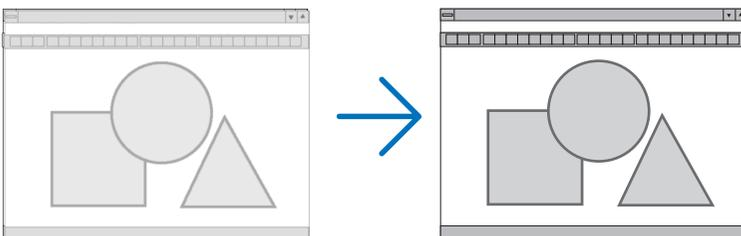
**PHASE** ..... Verwenden Sie diesen Punkt für die Einstellung der Taktphase oder zum Beseitigen von Videorauschen, Punktinterferenzen oder Einstreuungen. (Dies ist offenkundig, wenn Ihr Bild zu schimmern scheint.)
