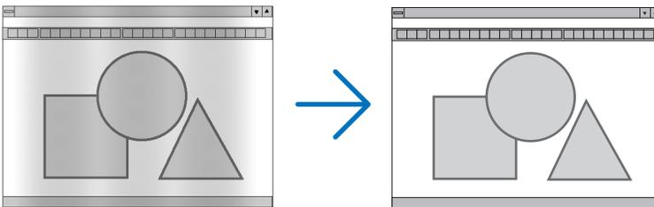
**TAKT** ..... Verwenden Sie diesen Punkt für die Feineinstellung des Computerbildes oder zum Beseitigen von möglicherweise auftretenden Vertikalstreifen. Diese Funktion stellt die Taktfrequenz ein, mit der horizontale Streifen im Bild eliminiert werden.
