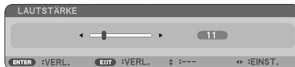
**TIPP:** Wenn kein Menü angezeigt wird, dienen die <- und >-Tasten am Projektorgehäuse der Lautstärkeregelung.
