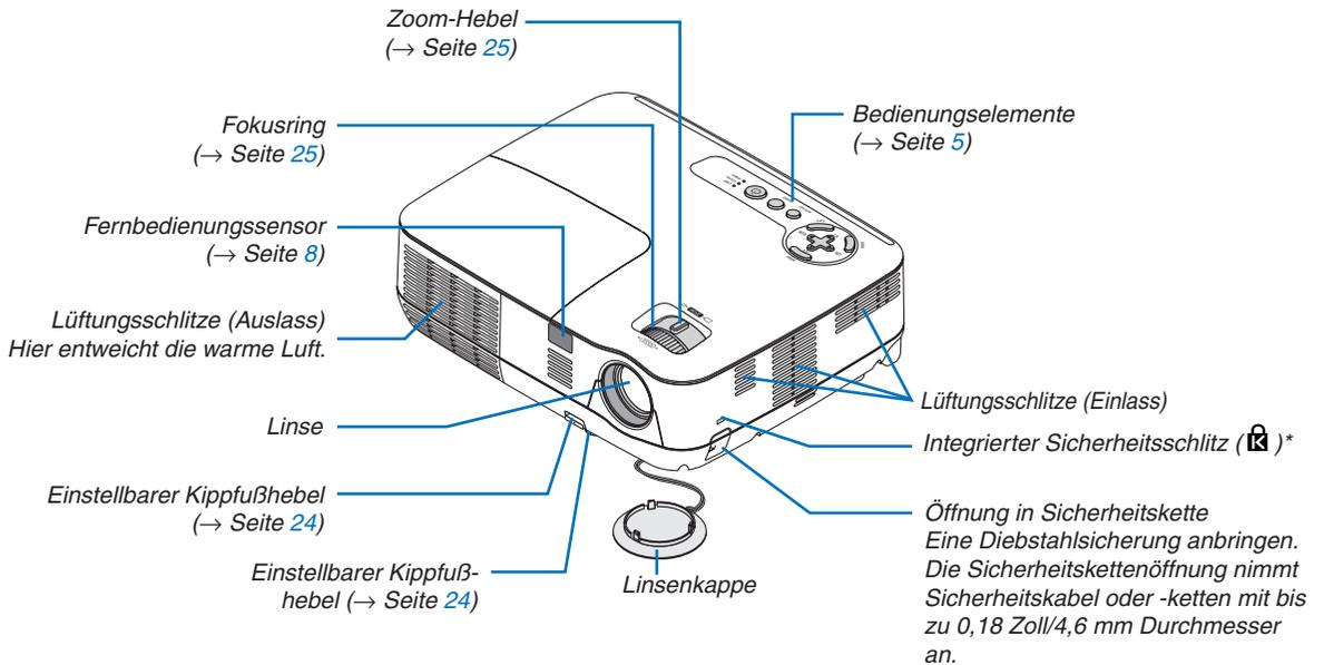
\* Dieser Sicherheitsschlitzz unterstützt das MicroSaver®-Sicherheitssystem.
