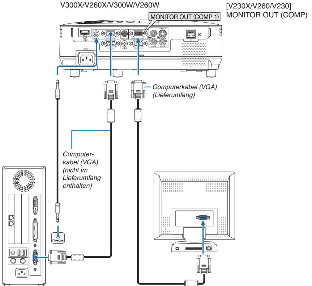
Sie können einen separaten, externen Monitor an Ihren Projektor anschließen, um sich während der Bildprojektion auf dem Monitor gleichzeitig das analoge Computer-Bild anzeigen zu lassen.
